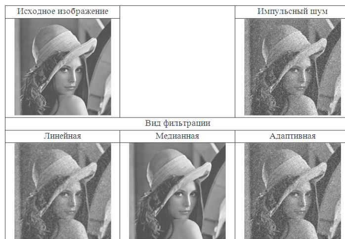
Рис. 1. Результаты фильтрации импульсного шума на изображении
