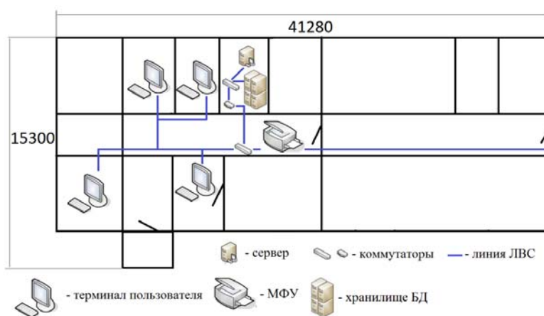
Рис. 2. Схема развертывания системы в административном блоке
