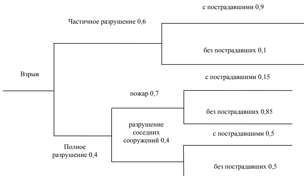
Рис. 2. Последовательность событий, возникших вследствие взрыва
