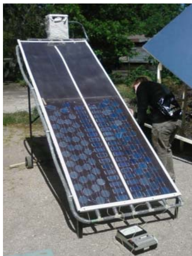
Термофотоэлектрическая солнечная установка на территории кафедры ВИЭСС в СевГУ
