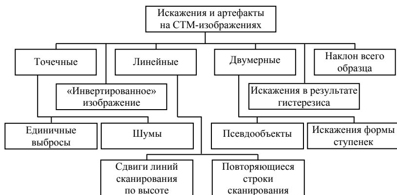
Рис. 2. Искажения и артефакты на СТМ-изображениях
